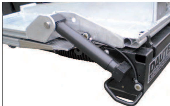
Siłownik hydrauliczny z solidnym zderzakiem przeciwnajazdowym z przewodem hydraulicznym Integral
